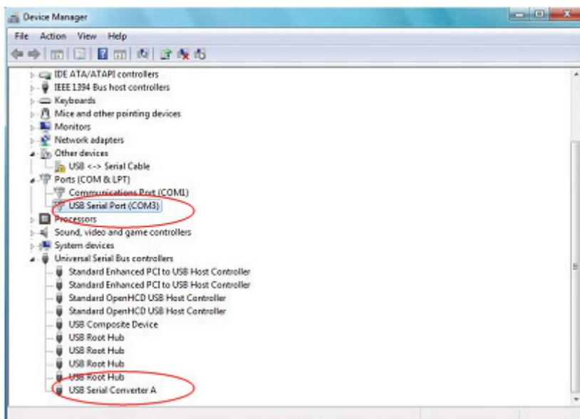
В этот момент у Device Manager нет записи USB <->Serial Cable под Other Devices, но будет изображена запись под Universal Serial Bus Controllers and Ports (COM & LPT). Верхний снимок с экрана показывает правильную установку. Устройство уже готово использовать COM3.
