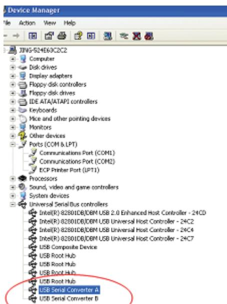
**Шаг А:** Нажмите правой клавишей мыши “USB Serial Converter A/ USB Serial Converter B”, затем нажмите “Properties”.
