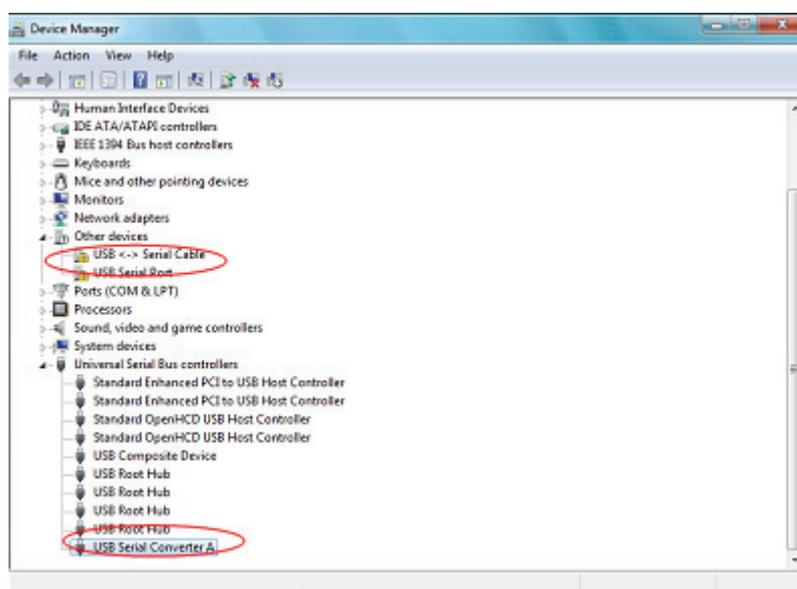
Device Manager все еще показывает устройство под Other devices, но в дополнение к этому появится новый элемент под Universal Serial Bus Controllers обозначенный на снимке с экрана как USB Serial Converter A. Это значит, что уровень шины драйвера установлен. Установка уровня Virtual Com Port почти полностью повторяет последние шаги.
